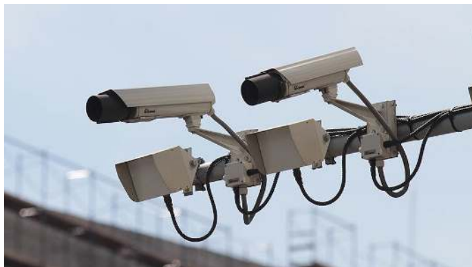
Рис. 1. Комплекс фото- и видео фиксации АвтоУраган.
