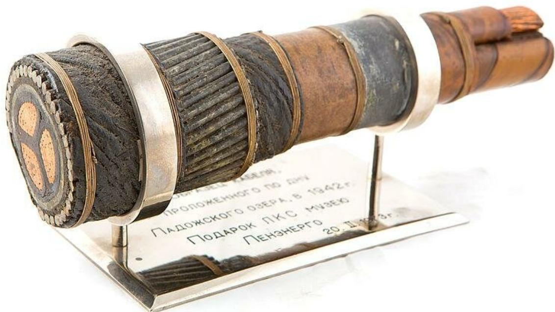
Рис. 9. Образец кабеля, проложенного по дну Ладожского озера в 1942 году.
