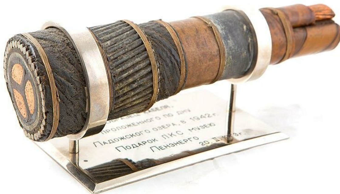
Рис. 9. Образец кабеля, проложенного по дну Ладожского озера в 1942 году. Фото: ПАО «Ленэнерго».
