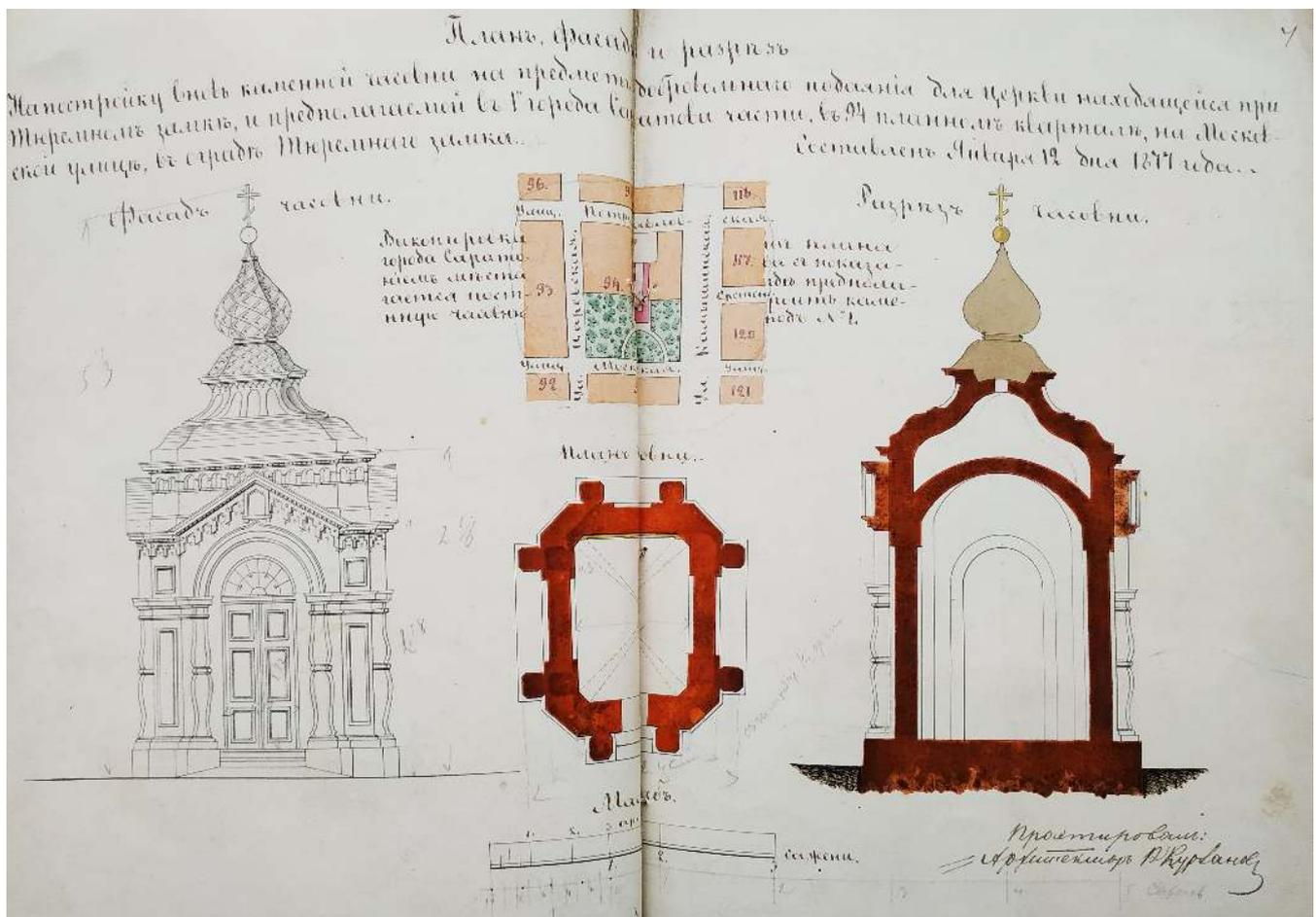
Рис. 1. План, фасад и разрез часовни при Саратовском тюремном замке.
